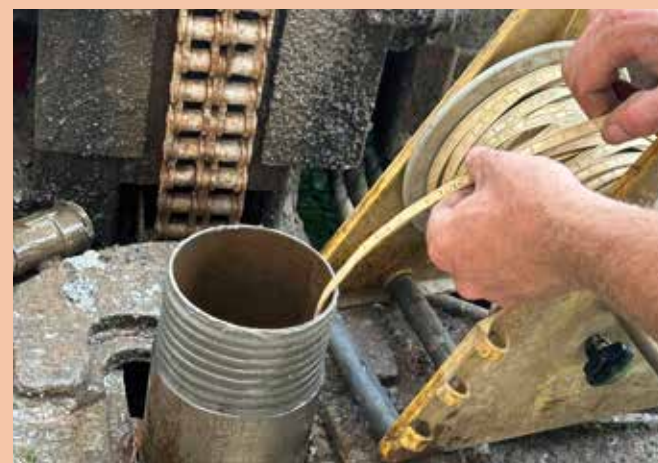
Enfin le prestataire a réalisé un essai de perméabilité des couches du sol sur une profondeur de deux mètres.
